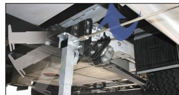
**Pojezd pro karavany** - neocenitelný pomocník pro snadnou manipulaci s obytným přívěsem (provedení automatické nebo poloautomatické).
